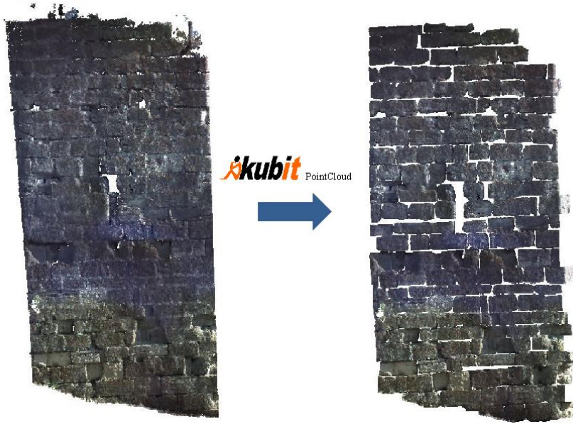
Şekil 4. Kuzey Kule'nin bir cephesine ait segmentasyon işlemi yapılmamış görünüm (sol) ve yapılmış görünüm (sağ)
