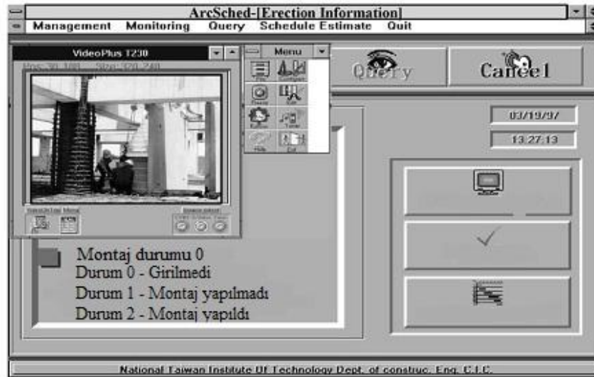
Şekil 8. ArcSched gerçek zamanlı montaj görüntüleme menüsü [31].
