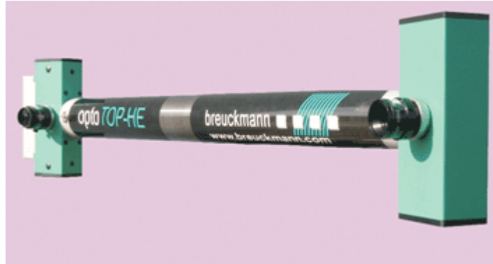
Şekil 6. 3B Optik lazer tarayıcı [4]
