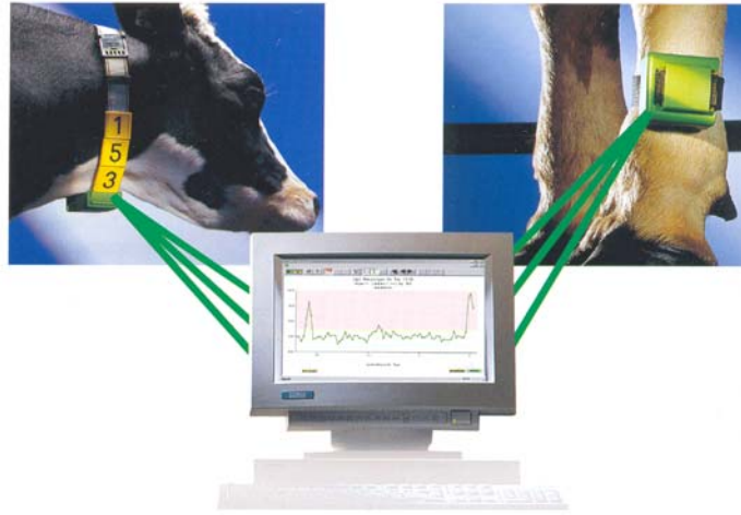
Şekil 3. Bir kayış ile boyun veya ayağa takılan tipte elektronik tanıma künyesi (WestfaliaSurge, 2003).
