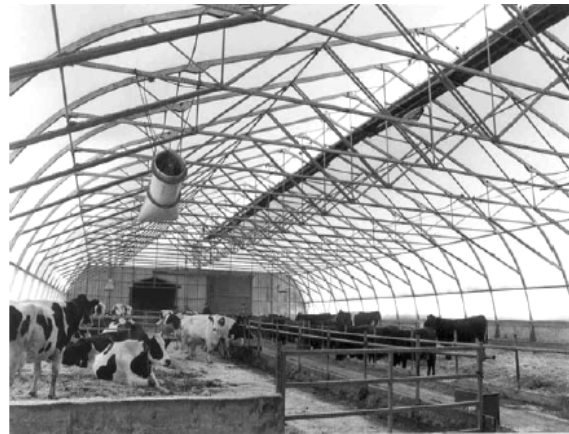
b) Düzlem kafes kirişli - oval çatılı ahır yapısı (Anonymous, 2005)
