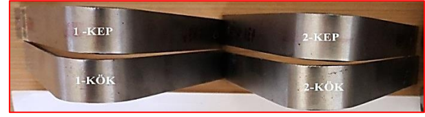
Şekil 12. Eğme numuneleri (Bending test samples)
