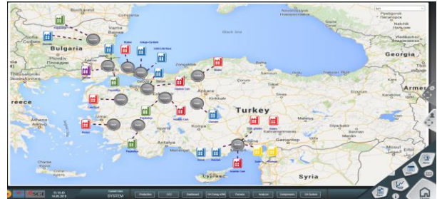
Şekil 12. Enerji yönetim sistemi SCADA'sı ana server açılış ekranı (energy management system SCADA main server screen)
