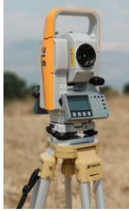
Şekil 3. Cygnus topcon ks-102 elektronik uzaklık ölçer
