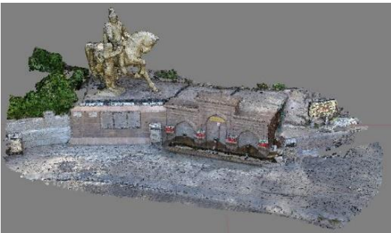
Şekil 6. Yoğun Nokta Bulutu (18,283,461 Point)
