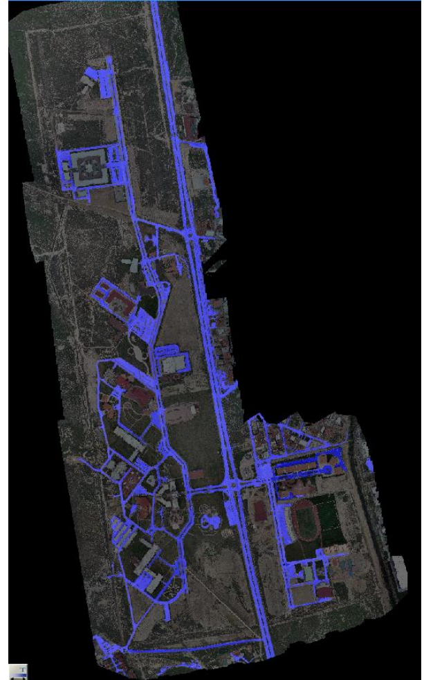
Şekil 8. Ortofoto Üzerinde Tespiti Gerçekleştirilen Yollar
