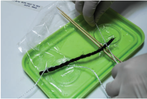
Şekil 19. Halatın uçlarının sağlamaştırılması (INA Arşivi)
