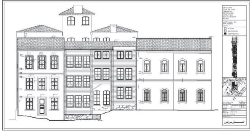
Şekil 20. Restorasyon önerisi 1: Arka cephe (güneybatı)
