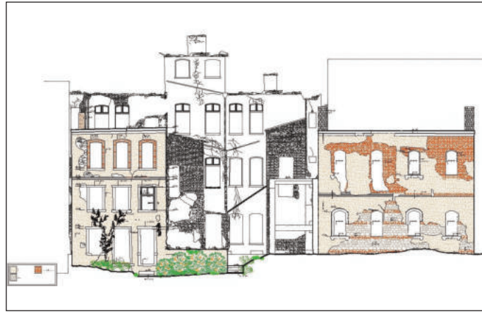
Şekil 14. Şapel arka (güneybatı) cephesi / rölöve
