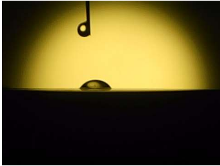
Şekil 5. Saf su damlacığının molibden numunesinin üzerine bırakıldığı andaki mikroskop görüntüsü
