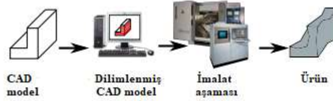
Şekil 1. Katmanlı imalat yönteminin işlem basamakları [6]
