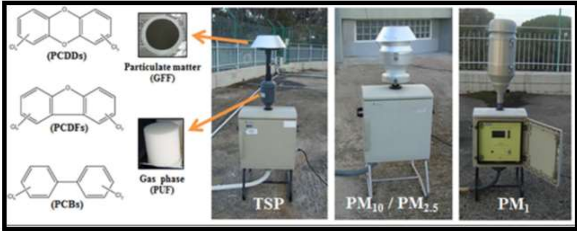
Şekil 3. İspanya'nın Madrid şehrinde yapılan çalışmada kullanılan farklı partikül madde başlıklı düşük hacimli hava örnekleyicileri
