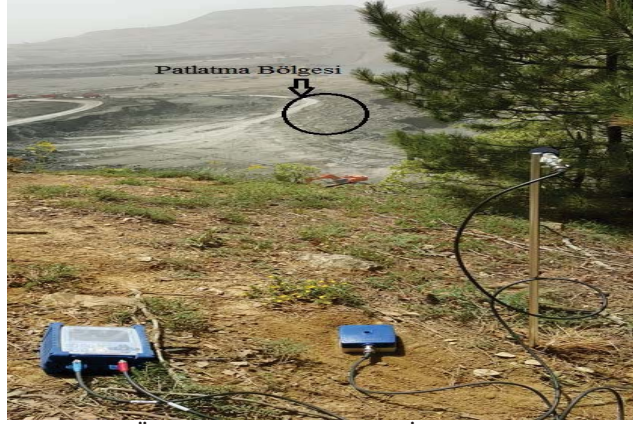
Şekil 2. Titreşim Ölçümünün Alındığı Yer İle Patlatma Yapılan Bölge
