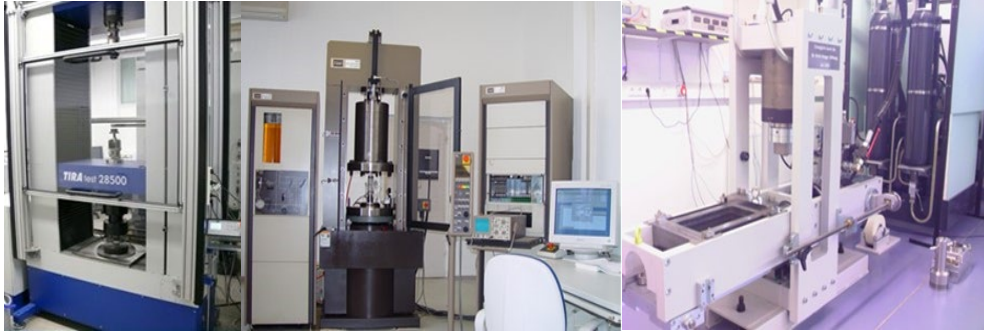
Şekil 1. Tek ve üç eksenli basınç deneylerinde kullanılan Compression System TIRAtest 28500, servo kontrollü MTS 815 ve kesme kutusu deneyleri için kullanılan GS 1000 kesme kutusu deney sistemi
