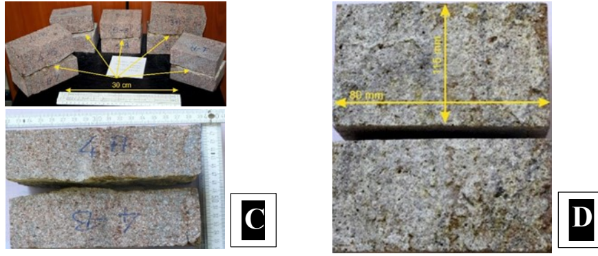
Şekil 3. A: Arazide andezit blok örneklerin görünümü, B: Andezitlerde gelişen akma bantlarının görünümü, C: Soğuma çatlaklarının görünümü, D: Soğuma çatlaklarının yüzey görünümü
