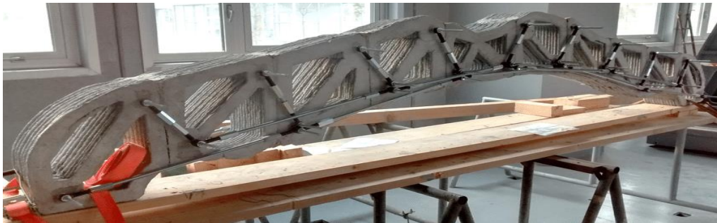
Şekil 10. 3D yazıcı ile üretilmiş prefabrik kiriş
