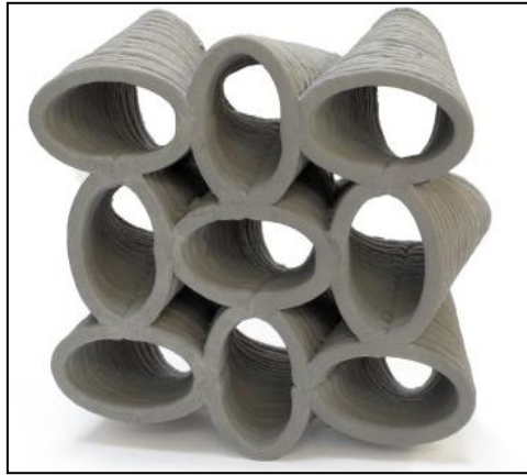
Şekil 7. 3D baskı beton ile üretilmiş akustik duvar sönümlenme elemanı [13].
