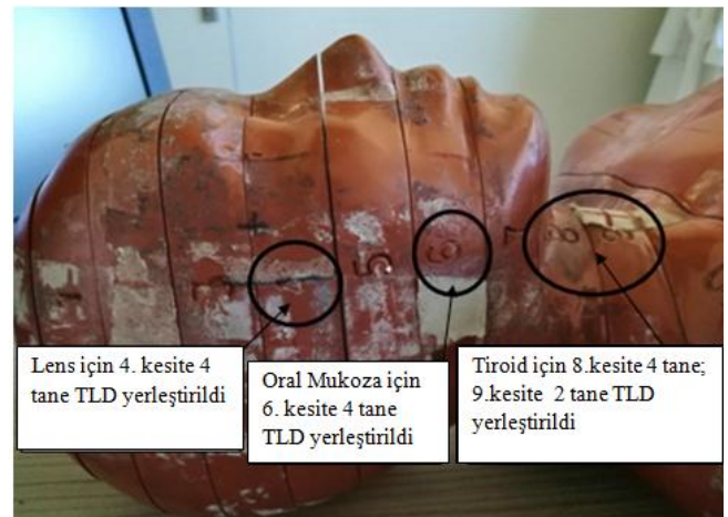
Çizim 1. Fantom üzerinde TLD'lerin yerleştirildiği kesitler
