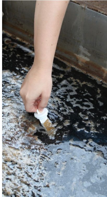
Fig.4 Biyolojik aktivasyonun yođunluđunun tespiti iin dipslide ile yapılan lmler.
