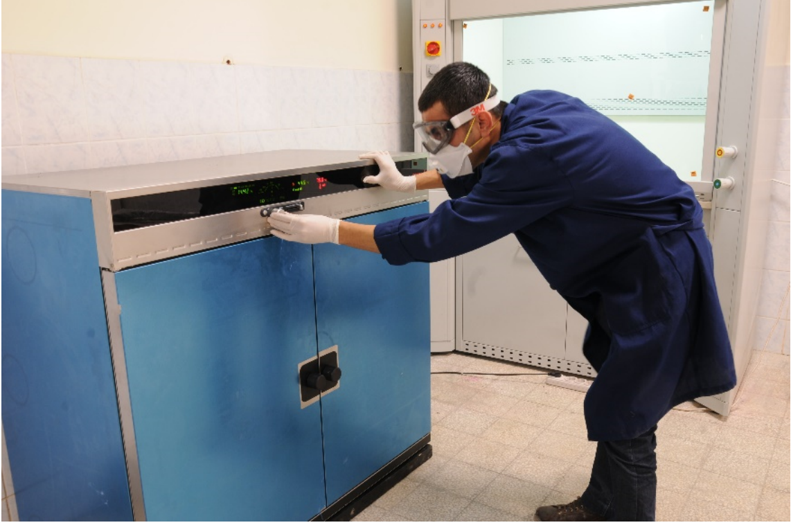
Fig. 3 amaltı Burnu 1 batıđı ahşaplarının su dođunluđunun tespiti alıřmaları.
