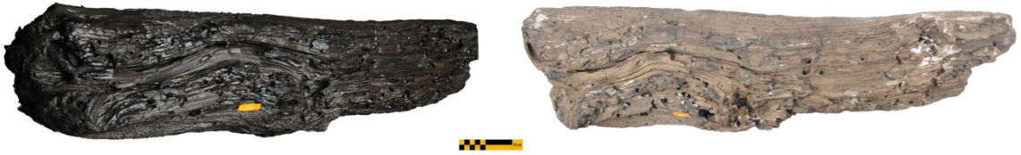
Fig. 14 Yoğun Teredo navalis saldırısına maruz kalan 6 no'lu parçanın konservasyon öncesi (sol) ve sonrası (sağ) durumu.
