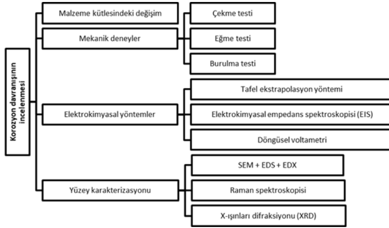
Şekil 4. Çelik halatlarda oluşan korozyonu tespit yöntemleri
