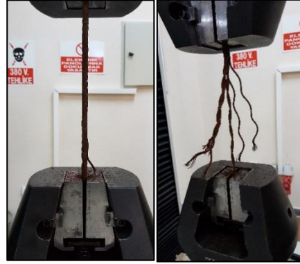
Şekil 10a. Çekme testinde tek bir kordonun kopması b. Halatın tamamının kopması
