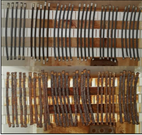
Şekil 6. Yaşlandırma öncesinde (üstte) ve sonrasında (altta) halatların durumu
