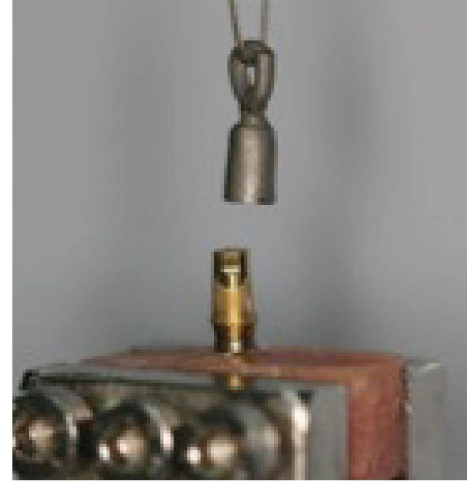
Şekil 2. Çekme testi sonrası metal alt yapı ve abutment yüzeyindeki artık simanın görüntüsü.
