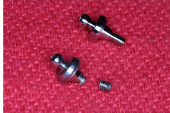
Şekil 5. Kırık ve yeni ball ataşman vidaları.
