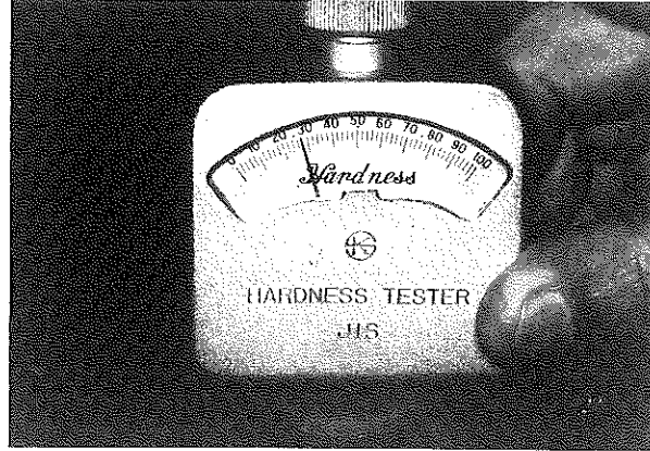
Resim 1: Shore-A sertlik değerlerinin ölçülmesi
