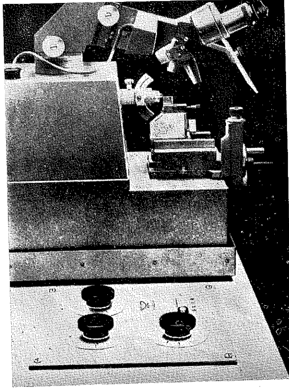
Resim 2. : Reichert OmU 2 Sutte Ultramikrotomu. (Cam bıçak ve blok monte edilmiş olarak görülmektedir).
