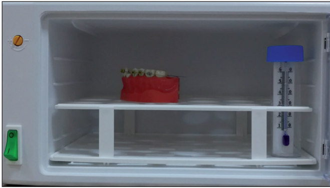
Şekil 2: İnkübatör ve ölçüme hazırlık sürecinde içinde muhafaza edilen fantom model ve dijital termometre.
