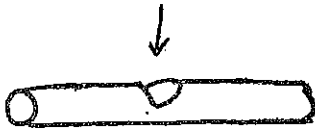
Şekil 1. Telde v şeklinde oluk açılması
