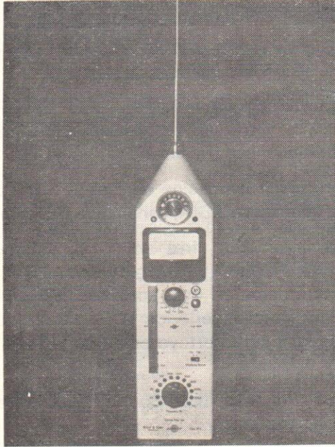
RESİM : 2 — BRÜEL AND KJAER MARKA Sound Level Meter (tip 2203), Oktav filtre seti (tip 1613), uzatma çubuğu (UA 0196) ve mikrofon (4165).
