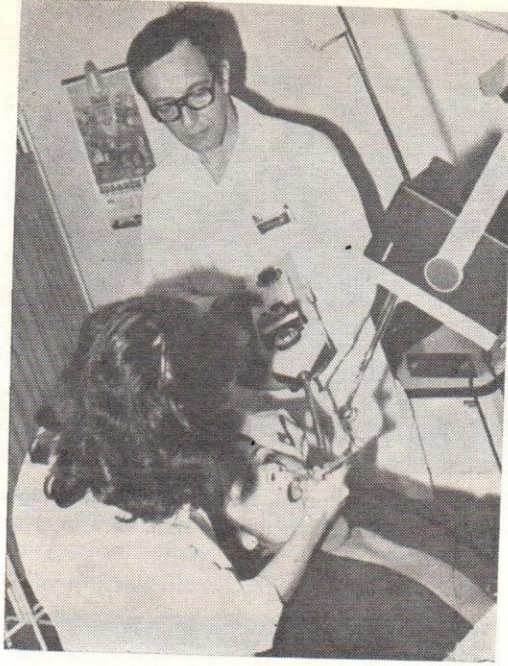
RESİM : 3 — Diş frezlenmesi esnasında hava yolundan gürültü ölçümü.
