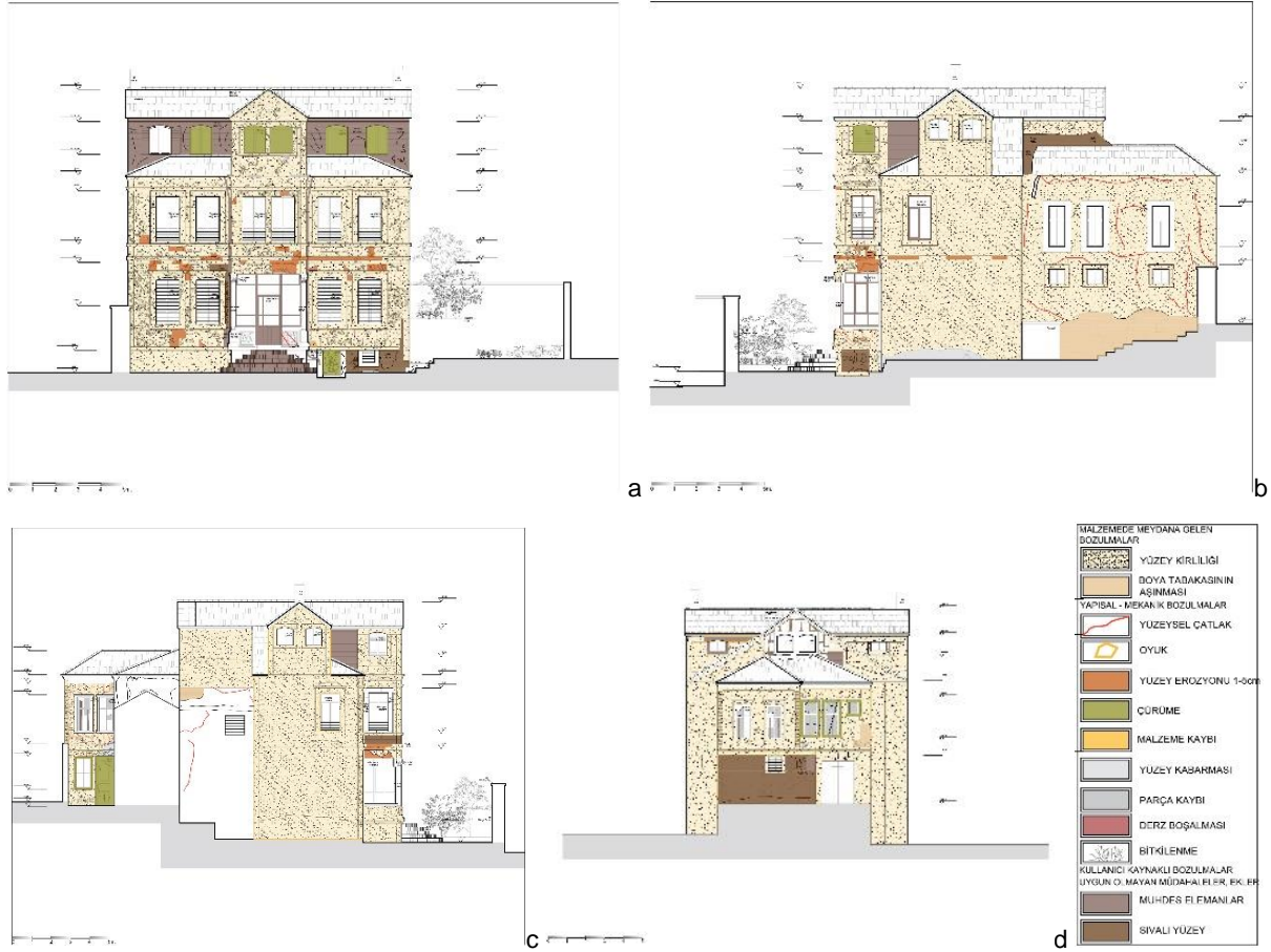
Şekil 15. Yapının cephelerine ait bozulma analizi
