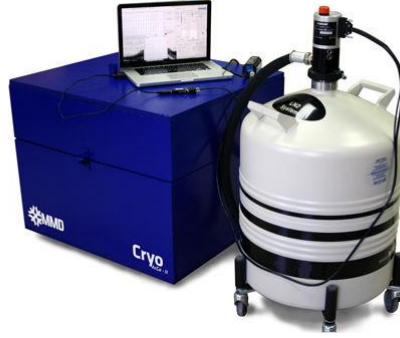
Şekil 2. Kriyojenik işlemin gerçekleştirildiği azot tankı
