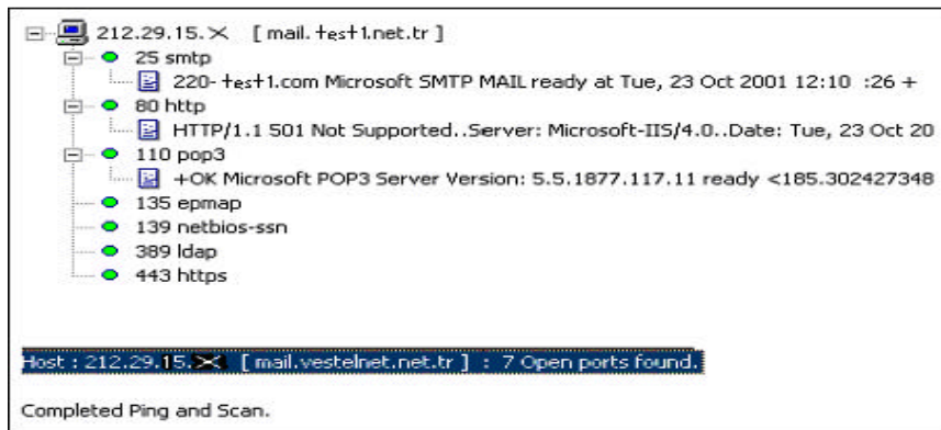
a ekil5 Bir Posta Sunucusunun Güvenilir Ağ Üzerinden Port Taraması Sonuçları
