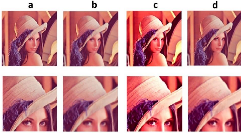
Şekil 5. Bazı örtüşme etkileri eklenen renkli görüntü ve yöntemlerin bu görüntü üzerindeki örtüşme giderici işlemler sonucu elde ettikleri görüntüler. (a) örtüşme içeren orijinal görüntü, (b) Ziou ve Horé yönteminin sonuçları (c) Perona ve Malik yönteminin sonuçları, (d) önerilen yöntemin sonuçları
