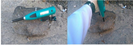
Şekil 7. Schmidt çekici ölçümleri
