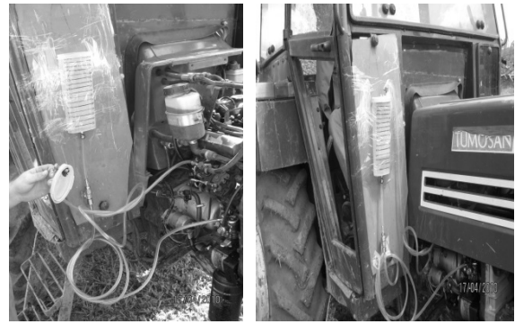
Şekil 1. Denemeler sırasında traktör yakıt tüketiminin ölçümü
