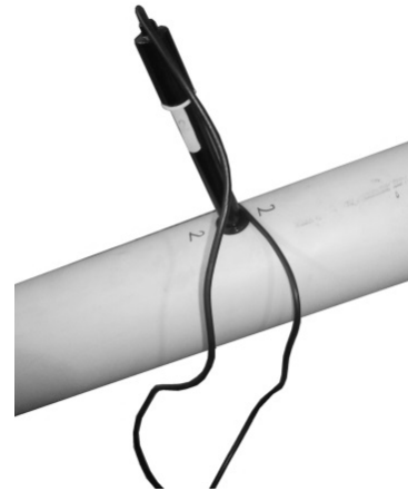
Şekil 6. Sulama suyu hattına bağlanan cam problu pH sensörü.
