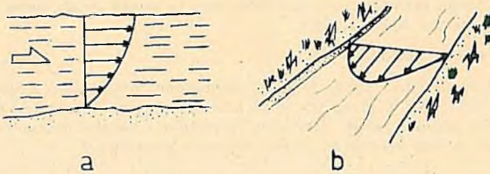
Şekil 2. Akarsu yatağının (a) düşey ve (b) enine kesit profillerinde akış hızı değişiminin şematik görünümü.
