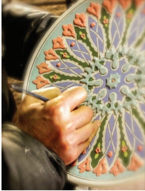
Şekil 7, 8, 9. Desen Basımı, Tahrir Çizimi ve Boyama (Ertuğrul Çini Fabrikası, Kütahya, 2016)
