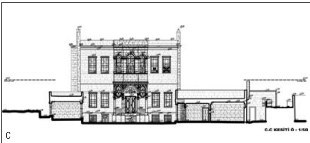
Şekil 26a, b, c, d. Konak ve Kolej dönemi restitüsyon projesi çizimleri (Kesitler)
