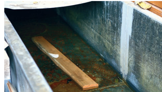
Batırma yöntemiyle empenye (KUDEB çalışmaları)
