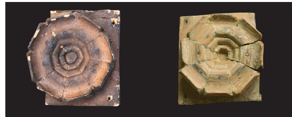
Kimyasal yöntemle boya sökümü yapılmış ahşap süsleme
