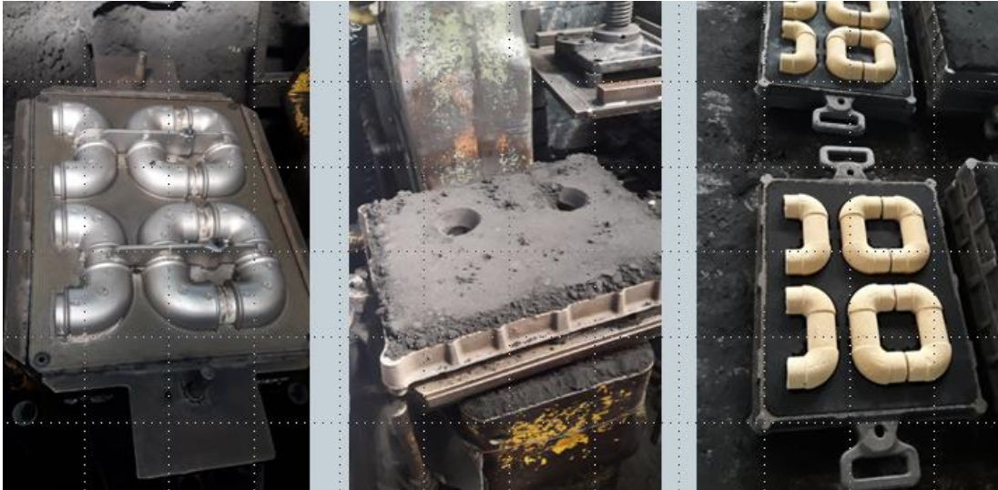
Şekil 2. Derece kalıplama (maçalı ürün)
