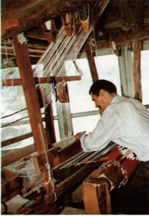
Resim 3 . Gaziantep Merkez, Mekikli tezgâhta kilim dokuma. Süleyman Ercan Kilim Atelyesi. Fotoğraf Fatma Durgul.
