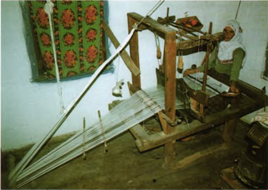
Resim 2. Mekikli el dokuma tezgâhı (çulhalık/düzen). 20 yıllık. Dokumacı Yaşariye Sanlı Evi. Ahmetbeyler Köyü/Göynük,1997.
