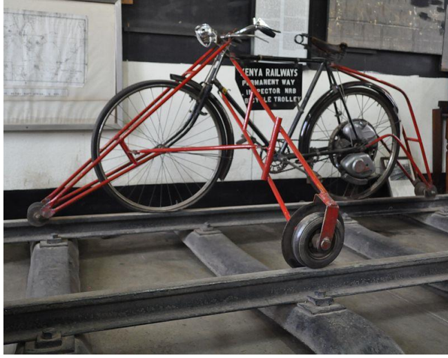
Şekil 1: Kenya’ da demiryolu müzesinde sergilenen geçmişte demiryolu hatlarının bakım ve kontrolünde kullanılan demiryolu bisikleti ( www.ru.wikipedia.org/2015 ).
