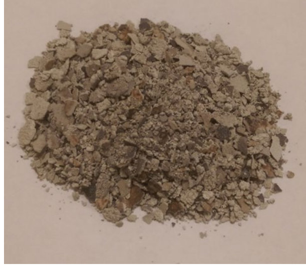
Şekil 2. Piston başından alınan depozitlerin görünümü
