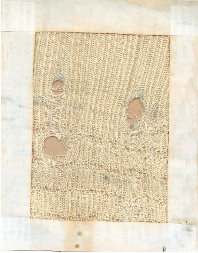
Şekil 3: Dilin kırılmasıyla oluşan delik
