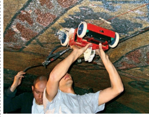
Jeoradar ölçümleri ile mozaik altındaki harç ve tuğla dokunun incelenmesi.
