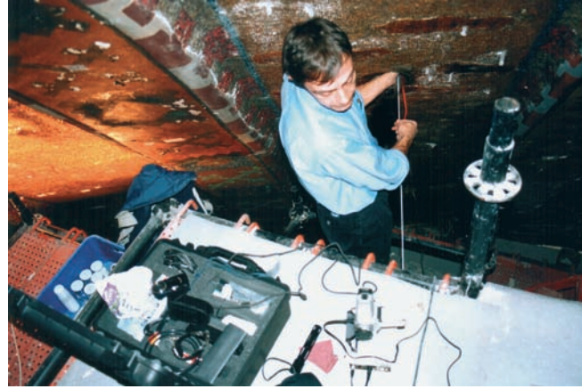
Endoskopi çalışması ile mozaik dokunun arkasının incelenmesi
