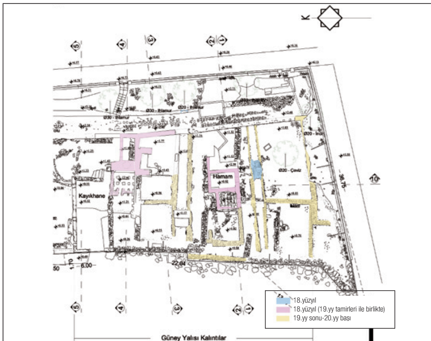
Şekil 22. Güney Yalı kalıntıları tarihsel değerlendirme paftası, Amcazade Hüseyin Paşa Yalısı, Anadolu Hisarı
