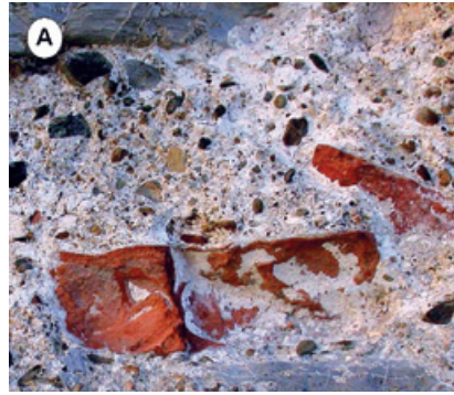
Şekil 4. Kalede kullanılan özgün krem (A) ve pembemsi (B) renkli horasan harcı örnekleri
