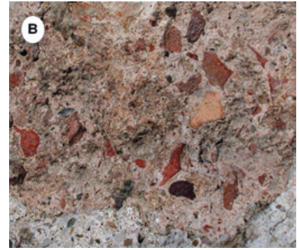
Şekil 4. Kalede kullanılan özgün krem (A) ve pembemsi (B) renkli horasan harcı örnekleri
