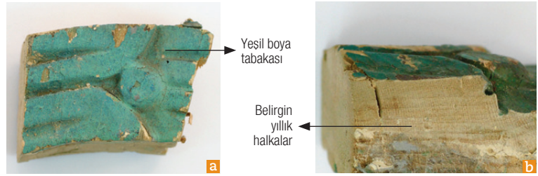
Resim 9. Ahşap kafesten alınan 6 numaralı örneğin makroskobik görünüşleri (a. üst yüzey, b. enine kesit)
