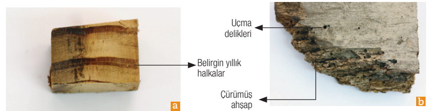
Resim 6. Döşemeden alınan 3 numaralı örneğin makroskobik görünüşleri (a. enine kesit, b. üst yüzey)
