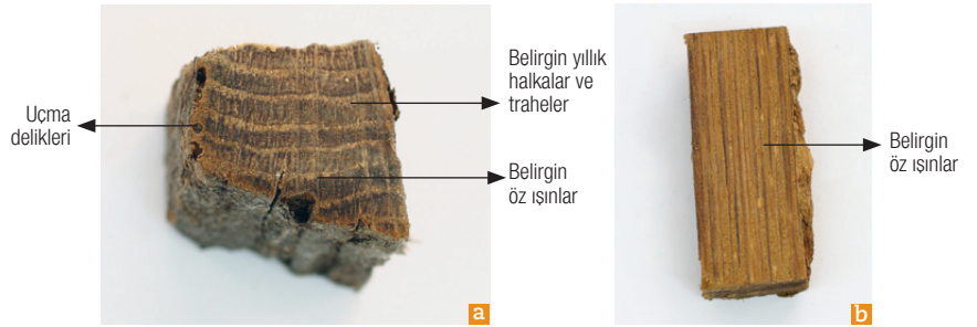
Resim 5. Ana dikmeden alınan 2 numaralı örneğin makroskobik görünüşleri (a. enine kesit, b. teget kesit)
