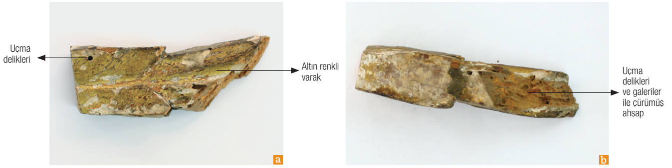
Resim 8. Hünkâr mahfiline çıkan merdiven korkuluğundan alınan 5 numaralı örneğin makroskobik görünüşleri (a. üst yüzey, b. yan yüzey)
