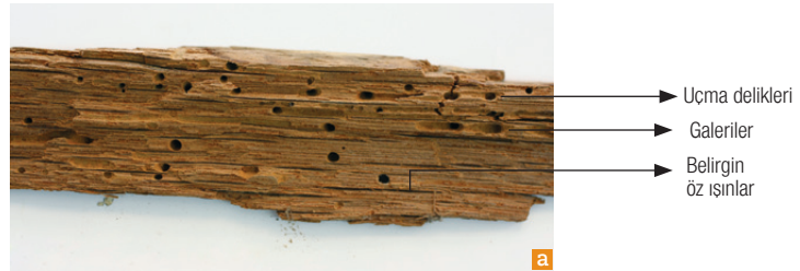
Resim 9. Ahşap kafesten alınan 6 numaralı örneğin makroskobik görünüşleri (a. üst yüzey, b. enine kesit)
