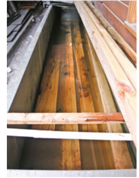
Resim 23. "Daldırma" yöntemiyle atölye ortamında emprenye
