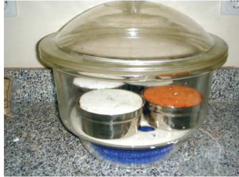
Resim 4. Su iticili numunelerin sabit nem ve sıcaklıkta desikatör içinde bekletilmesi
