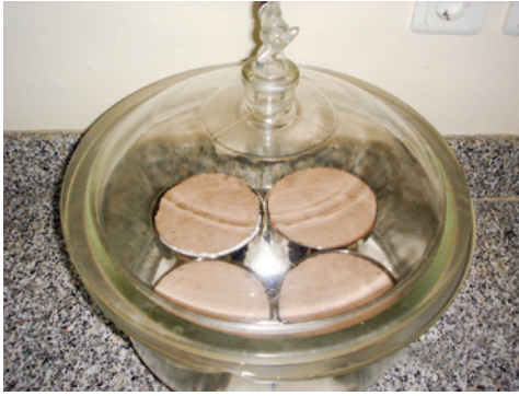
Resim 3. Boyalı numunelerin sabit nem ve sıcaklıkta desikatör içinde bekletilmesi
