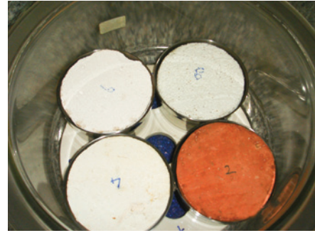
Resim 2. Kapların sabit nem ve sıcaklıkta desikatörde bekletilmesi
