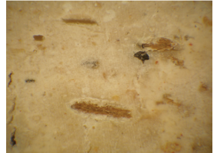
-----2 mm----- (Tek Nikol, Stereo Mikroskop) Resim 58. Örnek 22'den detay. Kırıntı parçaları, tuğla tozları ve siyah cüruf parçacığı.
