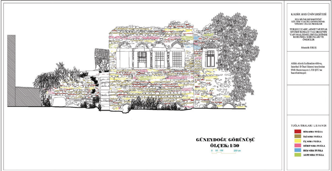
Şekil 2. Yapının Güneydoğu cephesi tuğla sıralarındaki farklılaşmalar
