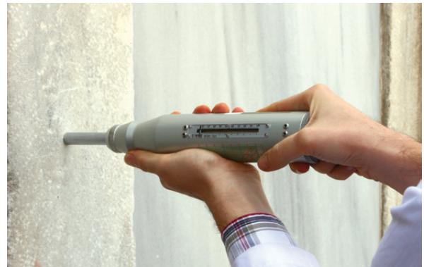
Şekil 7. Örnek alma imkanı olmayan yerlerde basınç dayanımının tespiti için, Schmidt Çekici ile rebound (geritepki) değeri ölçülebilir. (KUDEB Rest. ve Kons. Lab., 2010).
