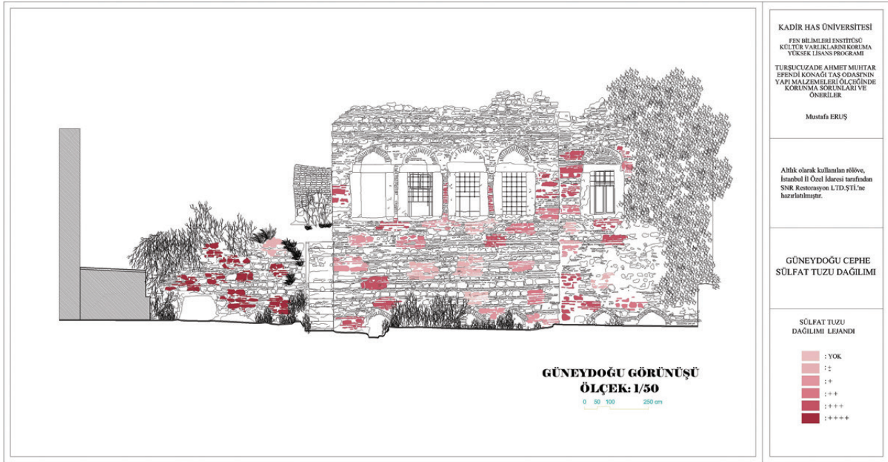
Şekil 19. Yapının güneydoğu cephesindeki sülfat (SO 4 2- ) tuzlarının dağılımı
