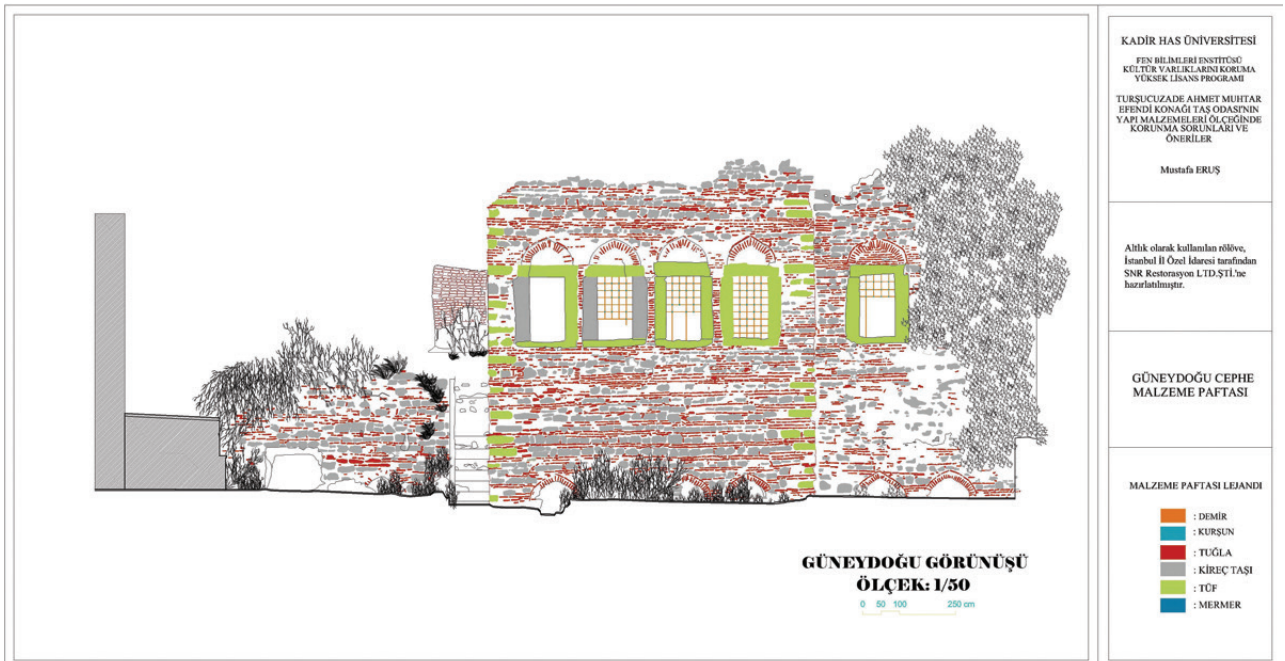
Şekil 15. Yapının güneydoğu cephesi malzeme paftası
