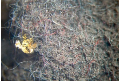
Şekil 8. Toz örneğinin mikroskop altında çekilen fotoğrafı, varak parçacığı ve havlar
