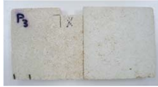
Sekil 7. %2 K_2SO_4 çözeltisinde ıslanma-kuruma çevrimlerinde 15. çevrimden sonraki resim, sağda uygulama yapılmış yüzey, solda uygulama yapılmamış yüzey (I.2.)
