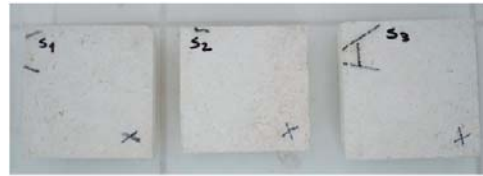
Sekil 8. %3 H_2SO_4 çözeltisinde ıslanma-kuruma çevrimlerinden önceki resimler (I.3.)
